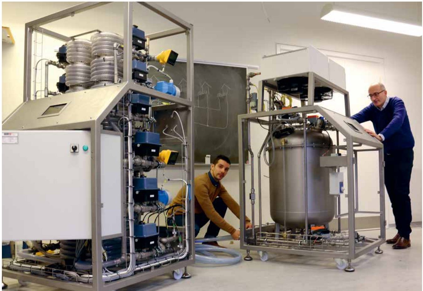
Testmoduler. Laboratoriet bliver et fleksibelt testområde med 14 byggesten, som kan bruges til at modellere forskellige vandnetværker.
